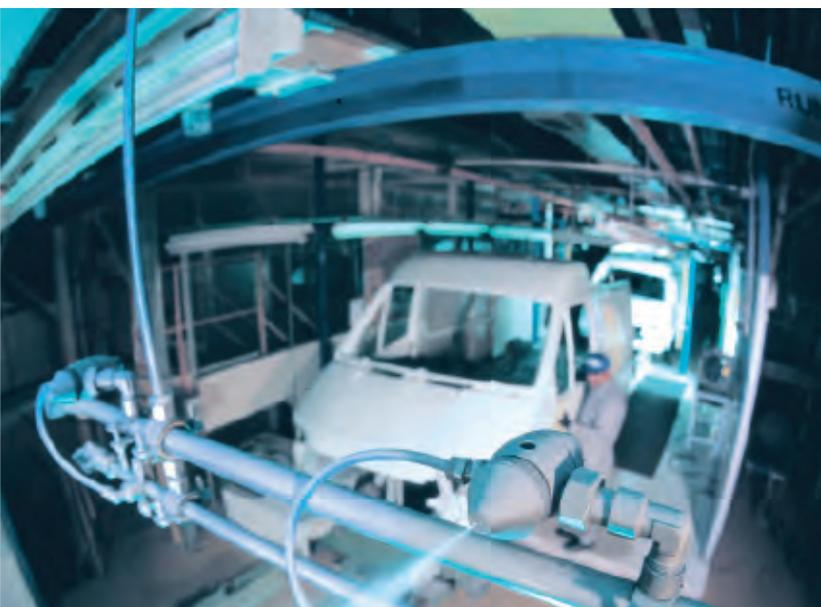
Humidificación en una instalación de pintura de vehículos
