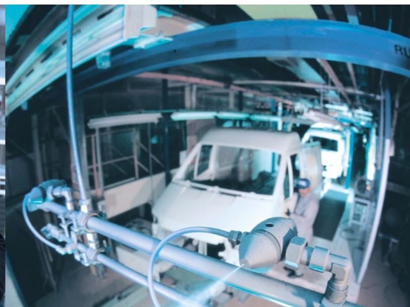
Umidificazione in un impianto di verniciatura di autovetture
